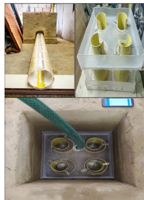
Figura 1. Caja de inspección, junto al disipador de energía Lampbrella y la incorporación de este al sistema.
