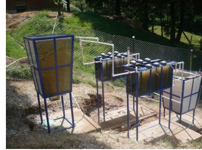
FUENTE: Planta piloto para el tratamiento de aguas residuales de la Quebrada mi Padre Jesús
