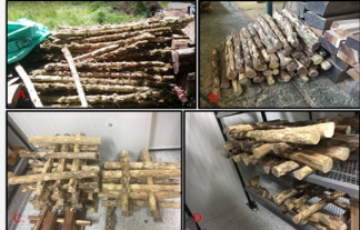
Figura 2. A. Madera rolliza apilada en carpintería; B. Madera seleccionada para probetas; C, y D. Madera ubicada en encastillado dentro del cuarto climático
