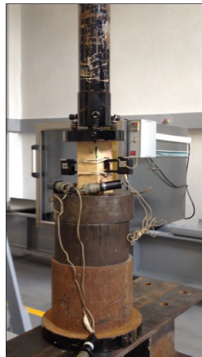
Figura 1. Foto de ensayo para obtención de módulos de elasticidad.
