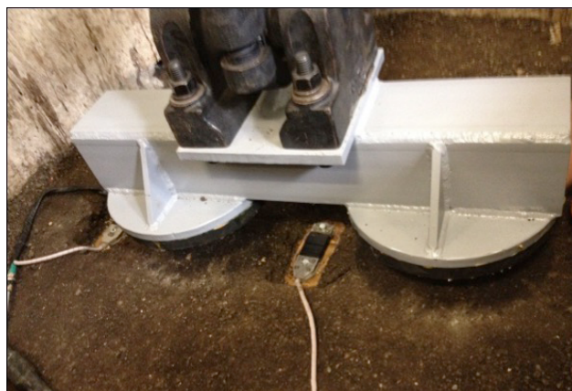
Figura 5. Ubicación de los sensores canal 0 y 1.
