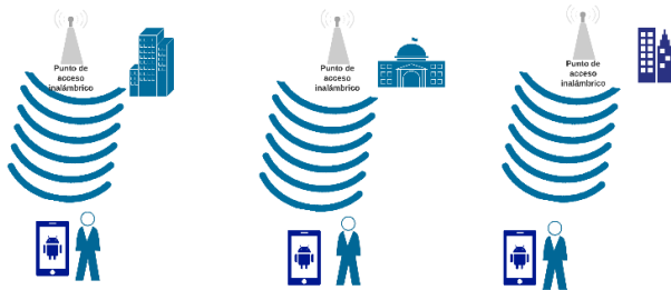
Figura 7. Nodos inalámbricos wifi como puntos de referencia.
