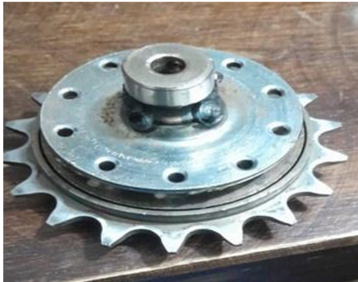
Figura 8. Sistema de acoplamiento entre el piñón y el rotor del motor generador.
