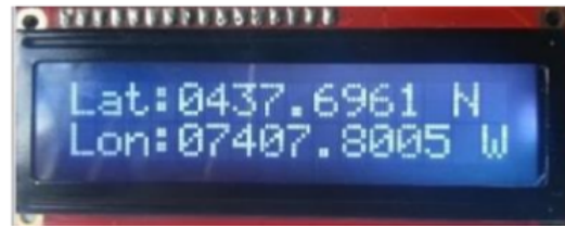
Figura 3. Visualización datos obtenidos GPS Latitud y Longitud LCD 16x2
