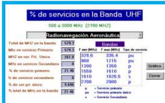
Figura No. 6 Distribución de frecuencias asignadas para uno de los servicios en la banda UHF
