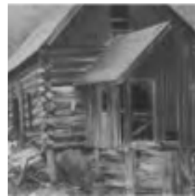
Figura 11. Oldmill comprimida con SA4 a 32:1 (0.25 bpp), PSNR = 28,47.
