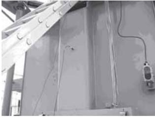
Figura 8. Acelerómetro en la pared del tanque del transformador
