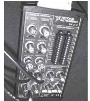
Figura 10. Tarjeta de Adquisición de Datos
