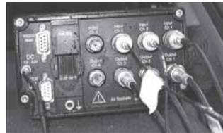
Figura 9. Amplificador de Señal de Cuatro canales
