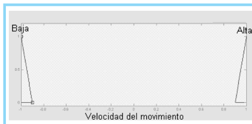
Figura 7 Conjuntos difusos de salida para el sistema de determinación de la velocidad.
