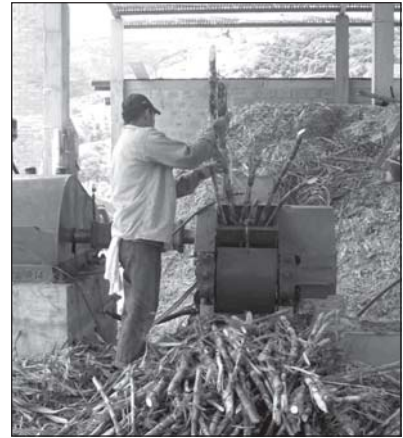
Figura 10. Extracción de jugos de la caña Fuente: Los autores.
