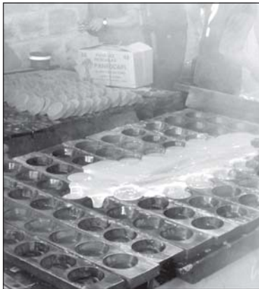
Figura 8. Proceso de moldeo de panela de una libra. Fuente: Los autores.
