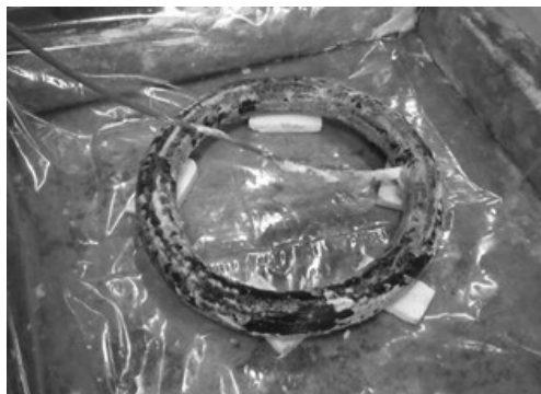
Figura 4. Dispositivo mecánico utilizado para la medición de la presión de expansión del poliuretano
