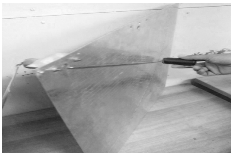
Figura 2. Combinación del flotador con potenciómetro.
