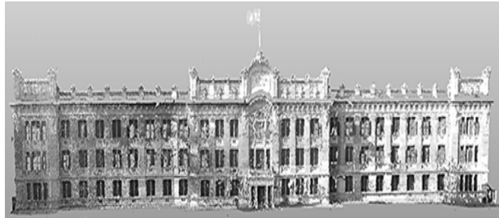
Figura 20. Nube de puntos 3D georreferenciada y texturizada de la fachada de rumbo sudoeste del Colegio Nacional.
