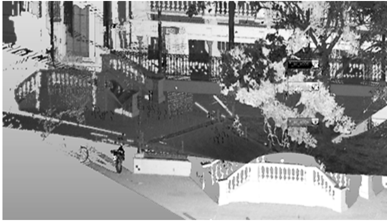
Figura 13. Dos escaneos en el edificio central. Se aprecia la alineación aproximada.
