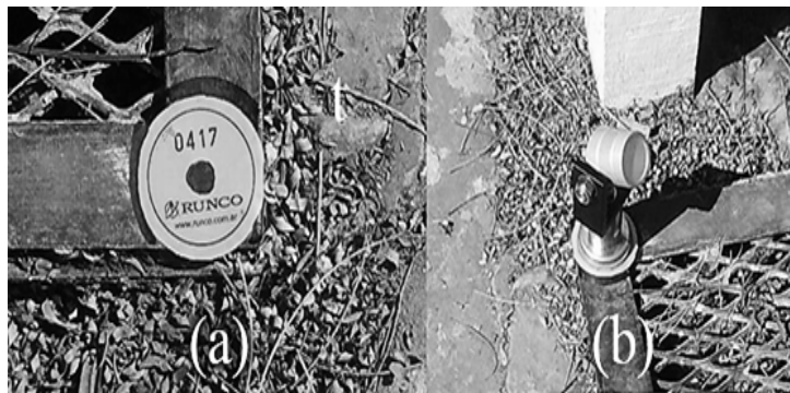
Figura 10. (a) Calcomanía utilizada en las mediciones, señala la posición de una esfera. (b) Miniprisma ubicado sobre la calcomanía para conseguir las coordenadas del punto central de la esfera que ocupó ese lugar.
