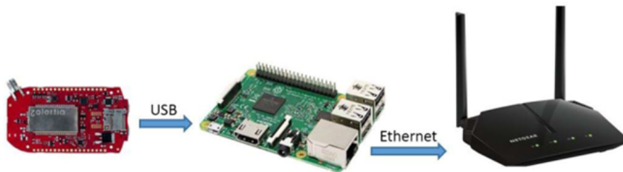
Figura 4. Arquitectura del nodo coordinador y el gateway para el despliegue de una red de sensores inalámbricos en casa de cultivo.
