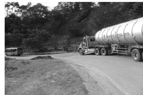
**Figuras 7 y 8.** Geometría de la vía. Curvas horizontales y verticales cerradas en pendientes y sin demarcación adecuada
