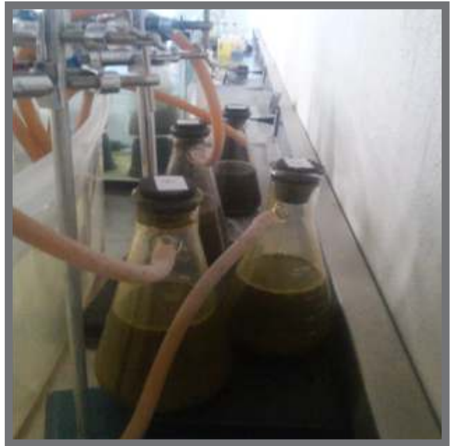
Figura2: Sistema de experimentación con matraces a 34 °C de excretas.
