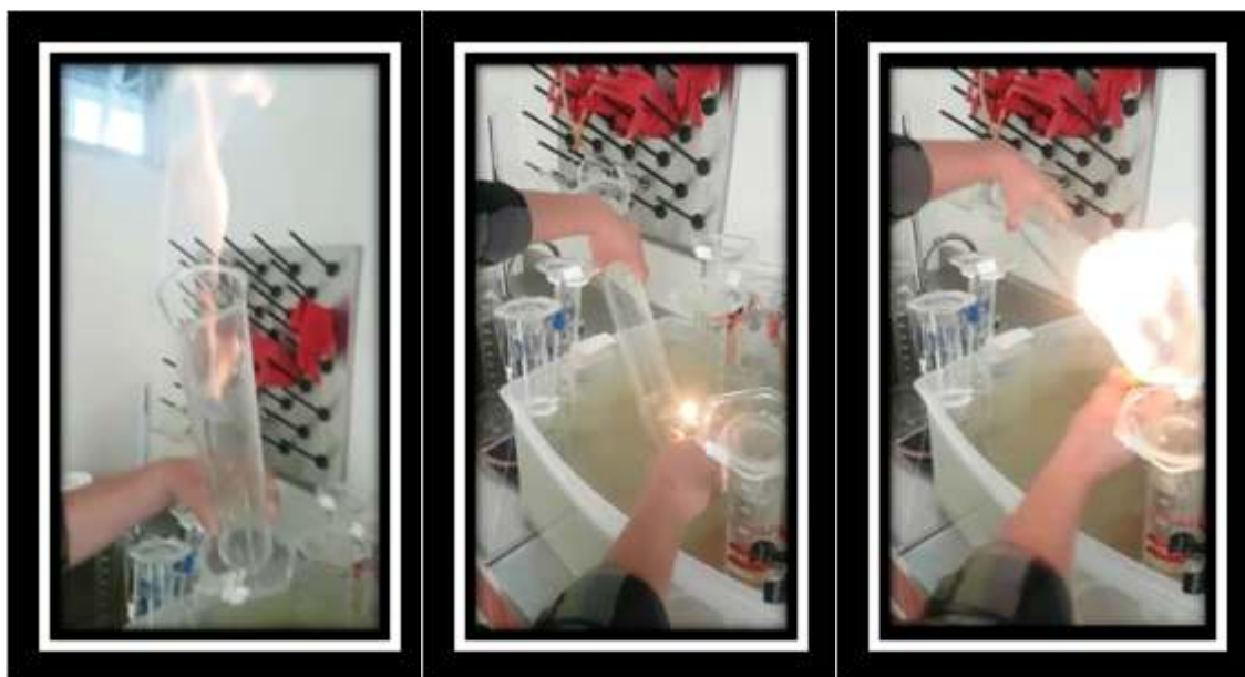
Figura 4: Prueba de la llama para identificación de metano en el biogás.
