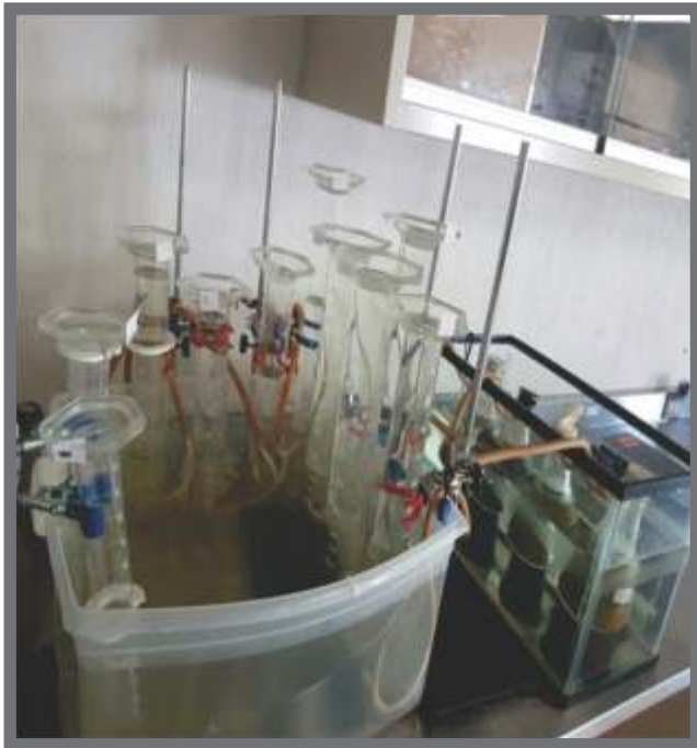
Figura2: Sistema de experimentación con matraces a 34 °C de excretas.
