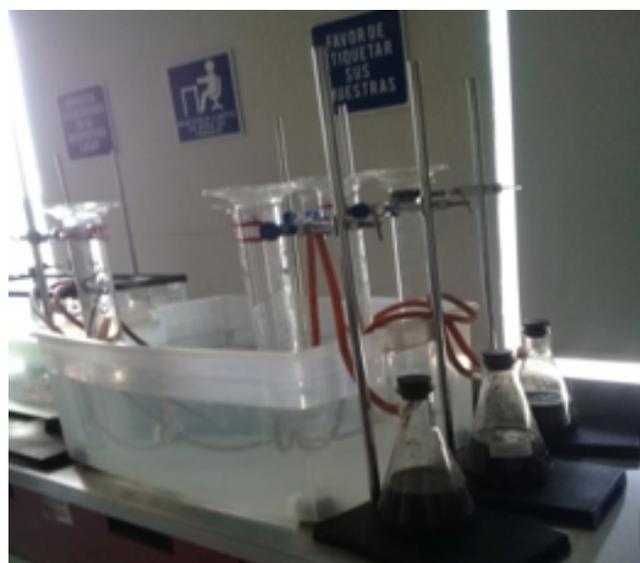
Figura 4: Sistema de experimentación con biodigestores a temperatura ambiente (22 °C). Fuente. (Elaboración propia, 2018).
