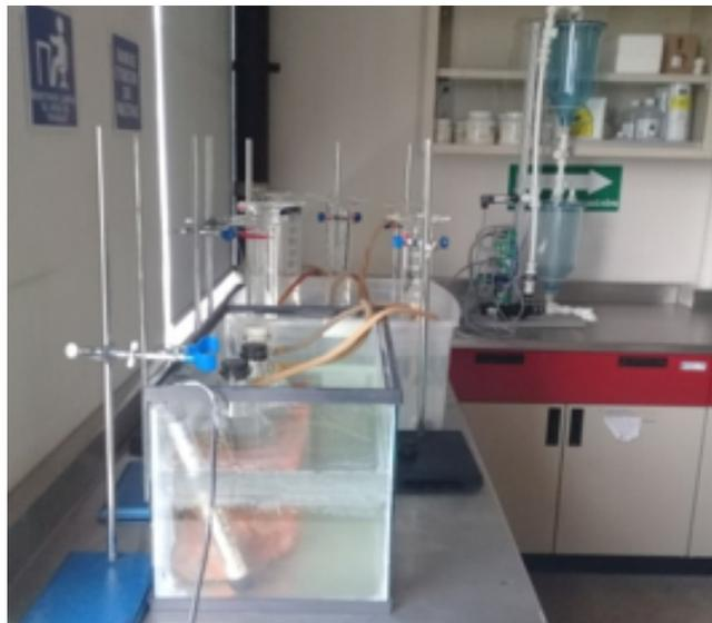
Figura 3. Sistema de experimentación con biodigestores a 34 °C de excretas. Fuente. (Elaboración propia, 2018).
