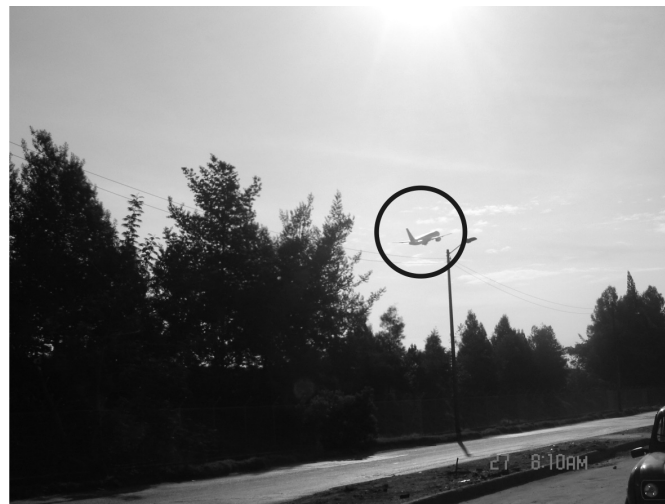
Figura 3. Estudio número 9 de las mediciones de campo paralela Avenida la Esperanza segunda pista. La aeronave de Avianca registró un LEQ de 81,6 dB como se observa viola el nivel máximo permitido de 65dB(A) para zona residencial según norma 8321 de 1983. Fuente: los autores
