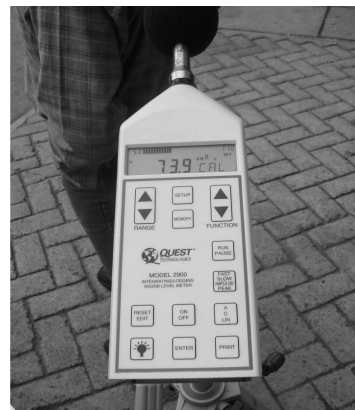
Figura 9. Sonómetro QUEST 9000 modelo 2000, con el cual se realizaron las mediciones móviles, en este momento se encontraba en la estación CAI Villa Luz, como se puede observar en este momento estaba marcando un evento de 73,9 dB(A) estaba ubicado a 1,5 m y a esta altura registra el tráfico vehicular. Fuente: los autores
