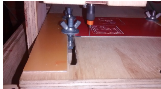
Figura 26. Parte 2 - Máquina fresadora CNC elaborando una PCB
