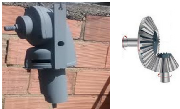
Figura 5. Multiplicador de velocidad (1000 W) de engranes Hipóide con dentado recto (González, Río, Tena, y Torres, 2011).
