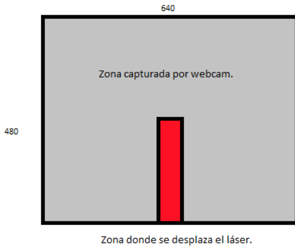
Figura 10. Zona de desplazamiento del láser capturado.
