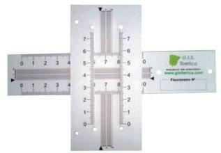
Figure 9. Fisurometer (GIS Iberica, 2017).
