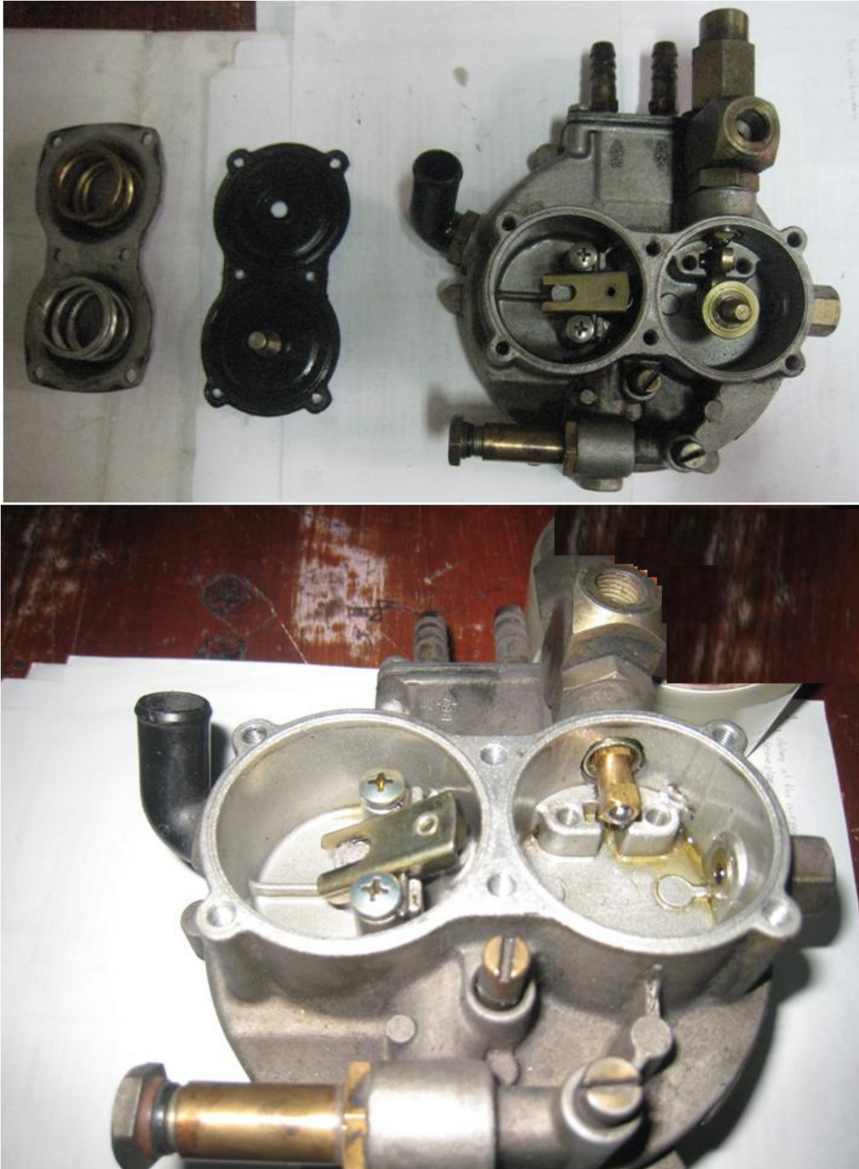
Figura 3. Modificación a la primera etapa de regulación del regulador de presión.
