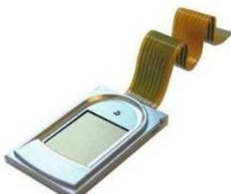
Figura 3. Lector de huella dactilar (ShenZhen Sanneng Security Technical, 2010).
