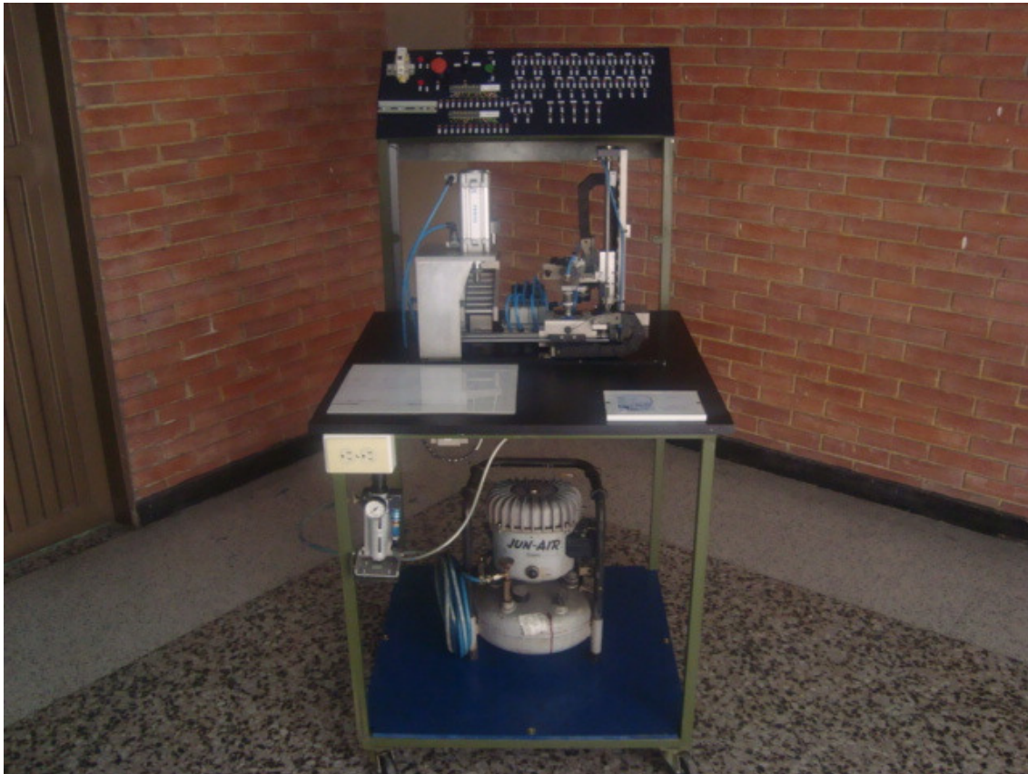
Figura 9. Sistema de vacío y PLC FESTO (laboratorio LE-MC-01).
