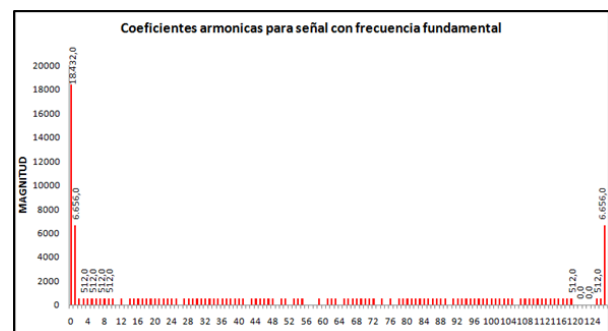
Figura 23. Resultado del prototipo para señal con frecuencia fundamental.
