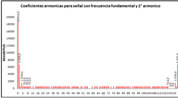
Figura 27. Resultado del prototipo para señal con frecuencia fundamental y segundo armónico.
