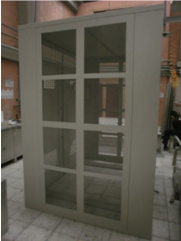
Figura 16. Fotografía celda de transformador con ventilación por malla IMT 20.
