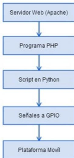
Figura 8. Diagrama de bloques de la etapa de comunicación.
