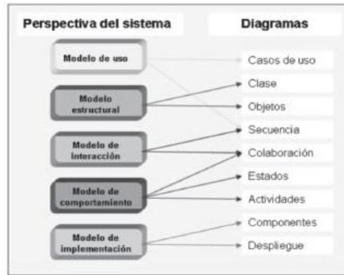
Figura 4. Tipos de diagramas UML según su perspectiva.
