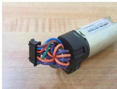
**Figura 2.** Motor DC Pittman 6214 con encoder.
