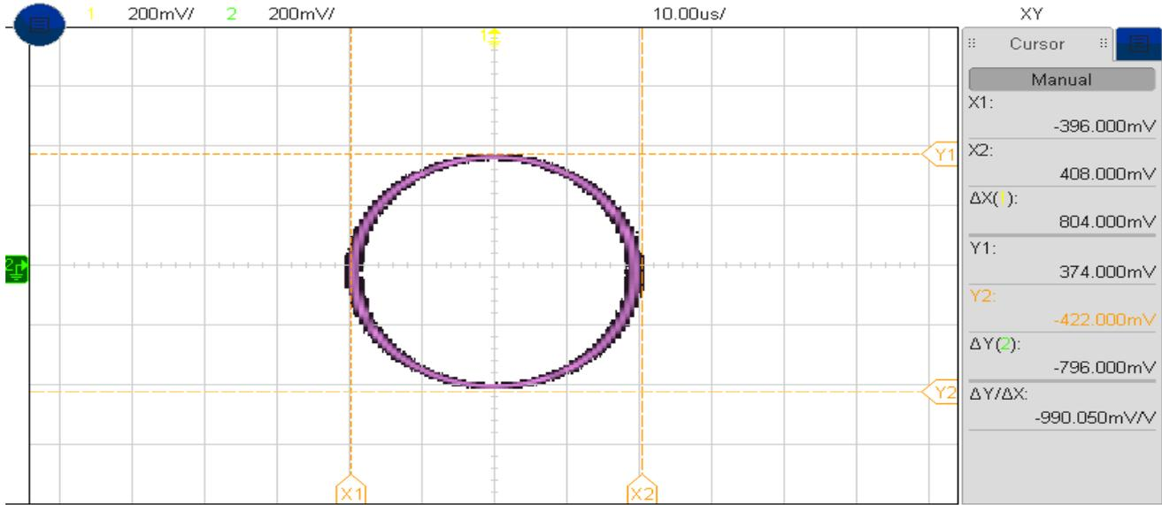
**Figura 8.** Constelación modulación 8QPSK.
