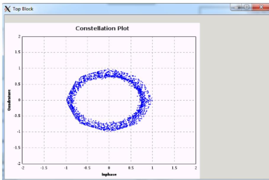
**Figura 14.** Constelación modulación BPSK.
