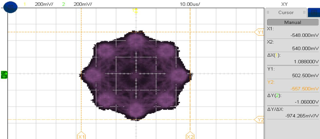
Figura 9. Constelación modulación BPSK
