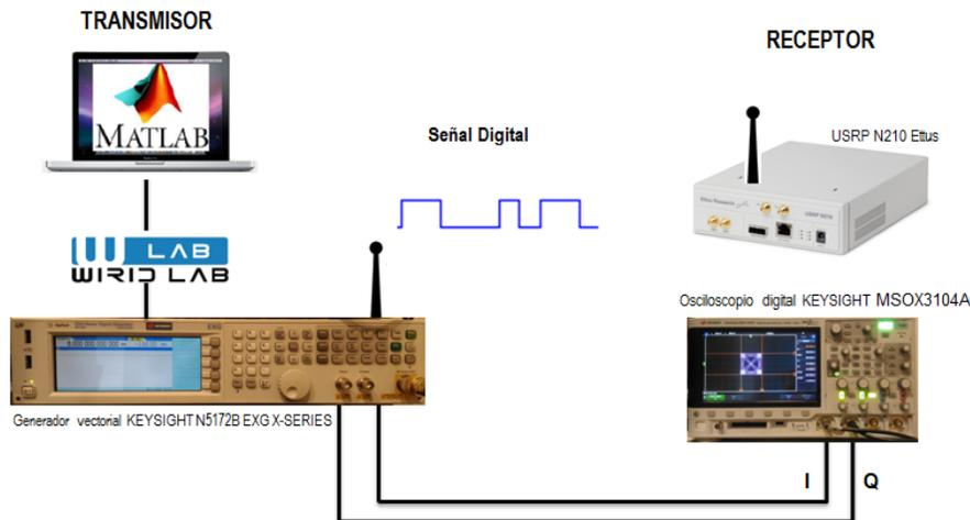
Para estas pruebas se desarrolló un código escrito en MATLAB para cada una de las modulaciones. El control del generador se realiza desde el computador usando el protocolo SCPI en Matlab, a través del comando `"connection= agt_newconnection ('TCP/IP', '80.0.0.10')"` configurando la dirección IP del equipo. Para la recepción de la señal modulada con el equipo USRP se creó en GNU Radio el diagrama de bloques que se muestra en la Figura 12. El diagrama inicia con
