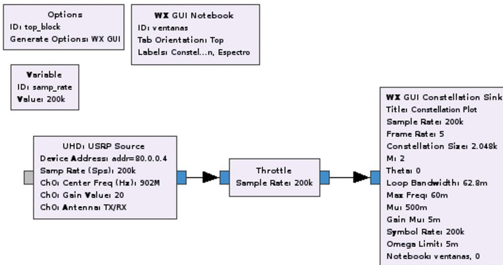
Para la generación de la modulación FM se creó un código en MATLAB. El resultado se evidencia mediante el software GNURadio una vez se recibe por la USRP como se ve en la Figura 13. Es posible ver la constelación de la modulación con una variación en fase y una amplitud constante característicos de la modulación FM.
