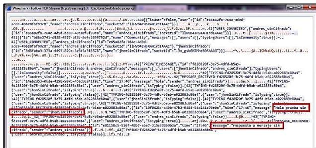
**Figura 8.** Captura de mensajes sin prototipo de cifrado. Fuente: propia.
