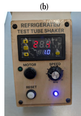
Figura 6. a) Monitoreo usando comandos de Telegram, b) panel de control en funcionamiento.
