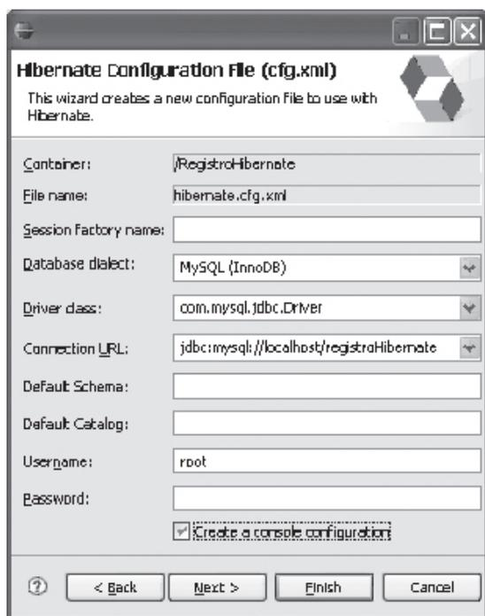
En el campo Driver Class se debe colocar el controlador de conexión de la base de datos, que en este caso es de MySQL. Connection URL contiene el servidor de la base de datos y el nombre de la misma.
