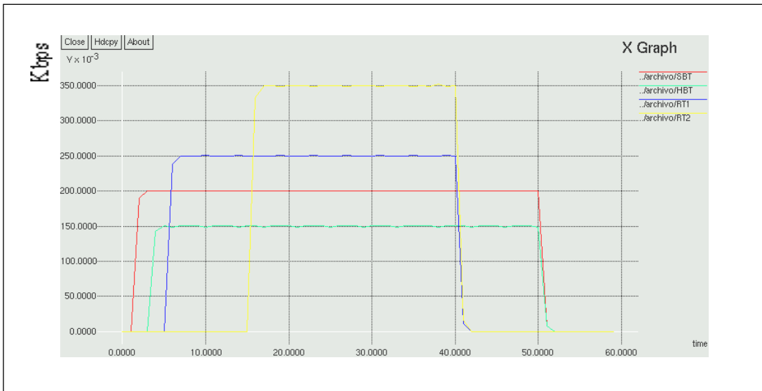
Gráfica 2. Ancho de banda utilizado por los diferentes tipos de tráfico
