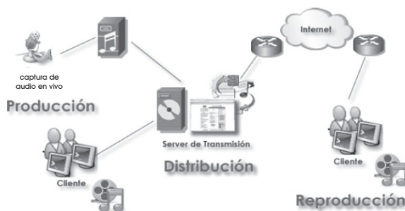
Figura 6. Arquitectura propuesta de tres capas para el componente de audio implementado.
