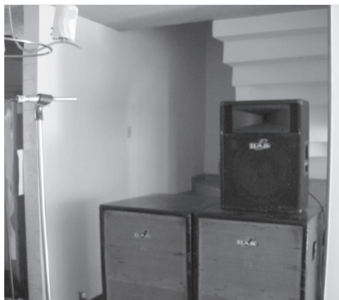
Figura 12. Fotografía del baffle marca Das referencia pf115 y del sub-bajo tipo DAS en el momento de la medición de su respuesta en frecuencia usando el Smartmaf
