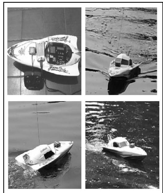
La prueba de ultrasonido se realizó instalando el módulo en la lancha de un Parque, figura 8. Acercándose a las orillas del lago, se obtuvo que el módulo ultrasonido detecta las orillas aproximadamente a 1.5m de distancia pero en algunas partes esa distancia se reduce a 1.2m debido a la densidad de pasto en las orillas.
